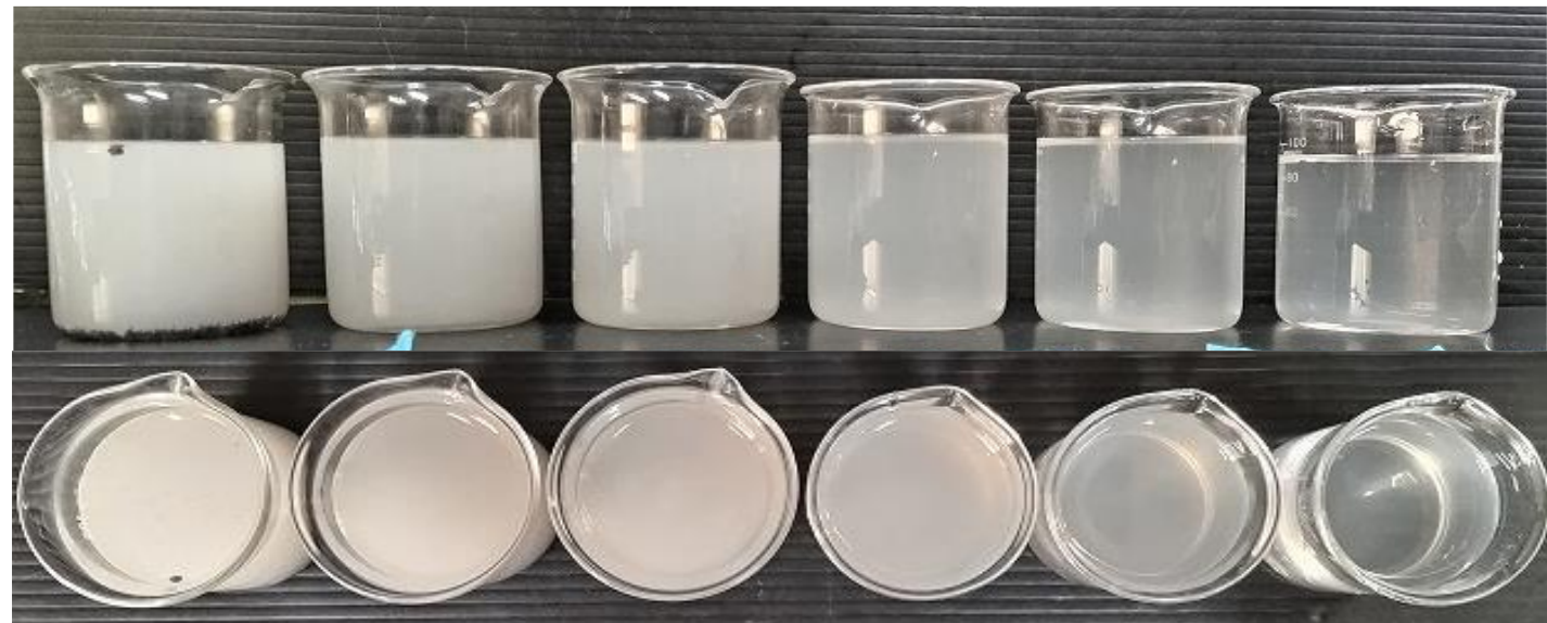
左から未処理、10、20、40、60、100ターン※3処理後のサンプルング液外観
