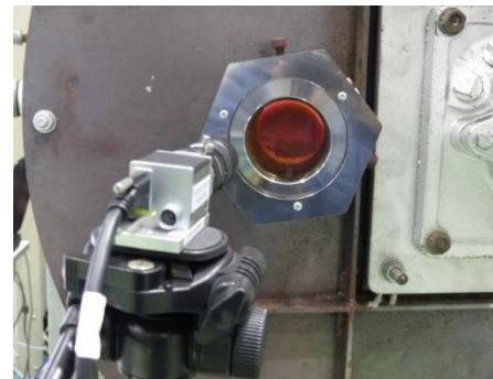
ガラス窓越しでの加熱炉内の被加熱物
