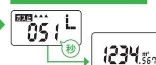
カウントダウンが終わり、ガス止または「L」表示が消えるとガスが使えます。
