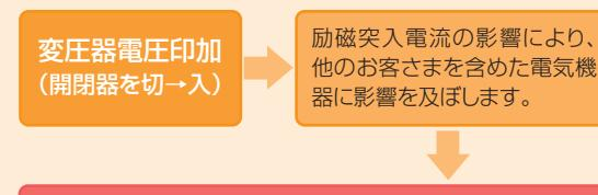
過去に励磁突入電流による電圧変動の影響で、下記のような事例が発生しております。
