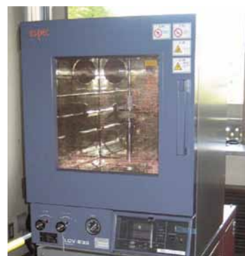
第2図 高周波誘電加熱式真空乾燥器
