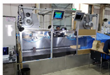
協力会社で試験用の冷却ラインを製作。 連続式に対応するため、下部のベルトコンベアを手で押して製品送りを再現した
