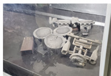
現場と同条件にするため、お借りした鑄造 自動車部品は砂を詰めて500℃まで昇温
