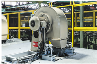
急速冷却装置は、ミスト、送風プロアで短時間に冷却をおこなう
