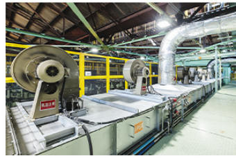
冷却工程には急速冷却装置を19基設置し、全長55mという短さを実現
