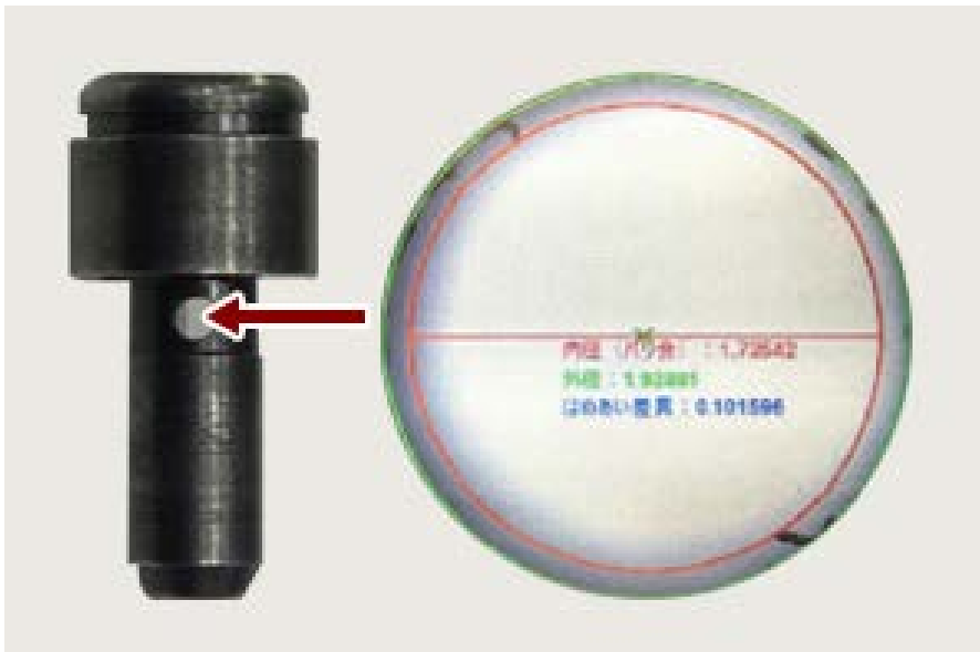
放電加工で開けられた2mmの極小な貫通穴を自動検査しなければならない
