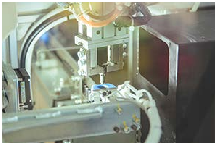
検査する製品をアームがつまみ上げ、回転させて穴を照明に向ける
