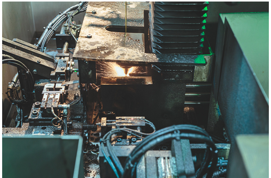
放電加工機で十字状に貫通穴が開けられる
