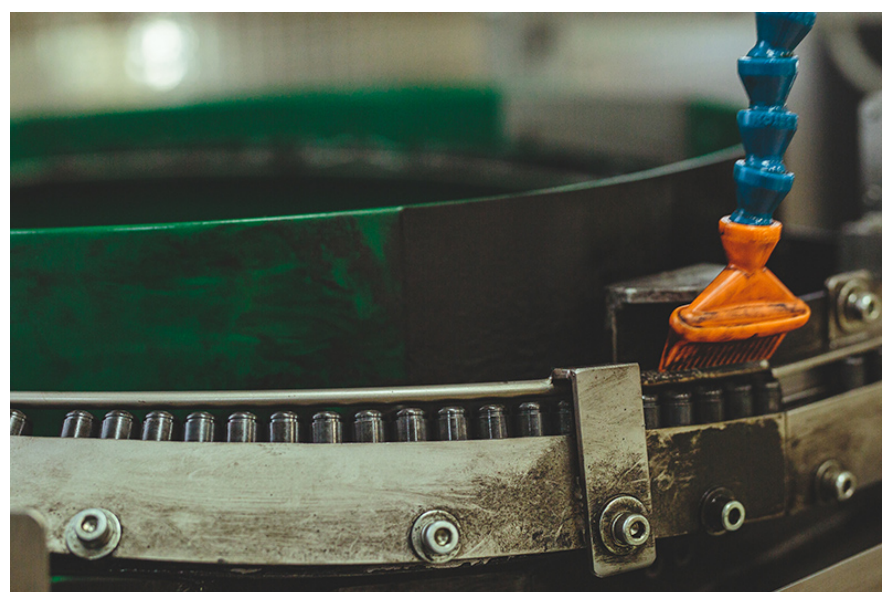
製品に付着した油脂を先にエアで吹き飛ばす
