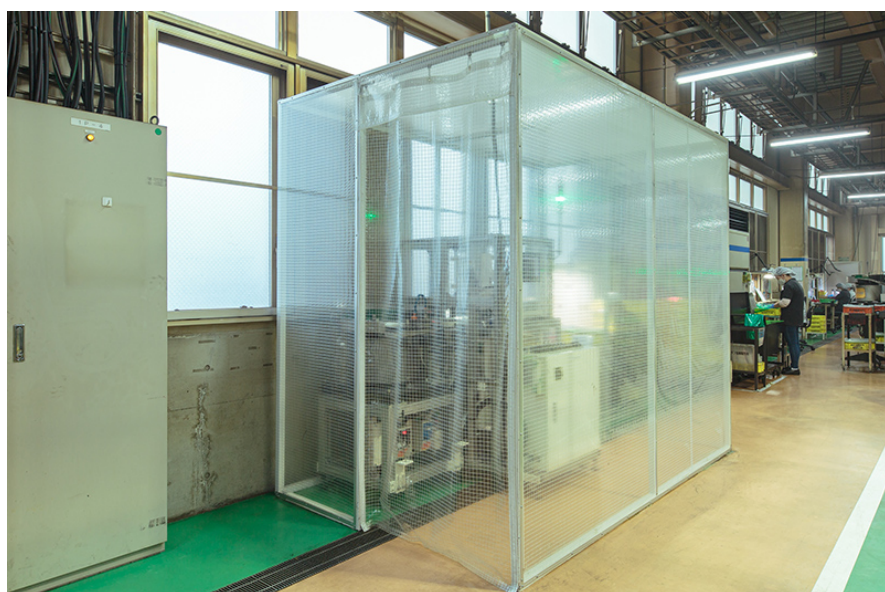
油煙保護用のシートでしっかり覆われた自動検査装置
