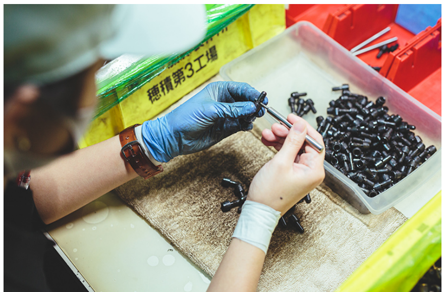
極小な穴の貫通有無はピンゲージを差し込んで確認
