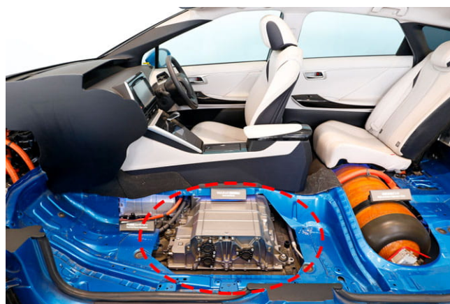
上部が燃料電池 下部が燃料電池フレーム
