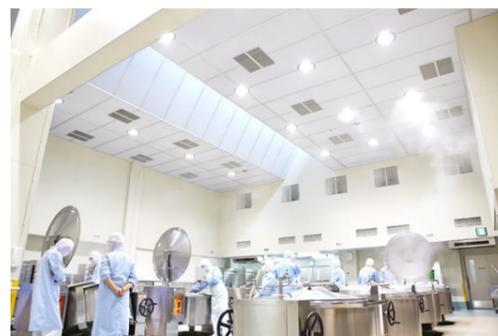
ずらりと並ぶ電気式回転釜で手順よく調理を実施。放射熱が無く、換気・空調も整備されているため、快適な作業環境を実現している
