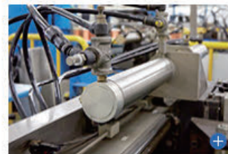
生産ラインの各設備は圧縮エアが主要動力源。様々なエアチューブが毛細血管のように張り巡らされている
