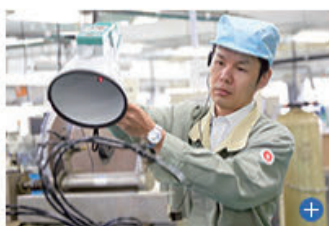
自社購入したリークディテクターで現在も漏気調査を定期的実施
