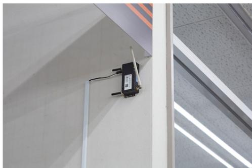
電力センサから収集された電力使用データを当社のクラウドサーバに送信するゲートウェイ。
