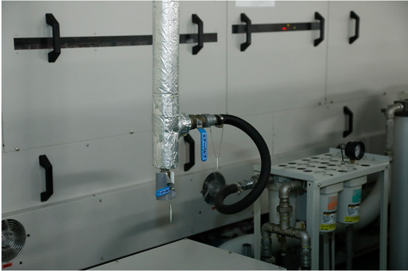
停止時の穴明け加工機は、圧縮エアの送気バルブを閉じ、エアの無駄を減らす。
