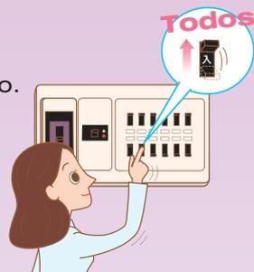
**7** Caso o interruptor de curto circuito volte a desligar automaticamente durante o passo 6, mantenha desligada apenas o interruptor que acionou a queda, ligando todos os demais.
