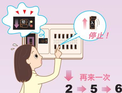
6の操作途中で漏电しや断器が切れたら、そのときの配線用しや断器だけを切り、再度漏电しや断器を入れてお使いください。切れている回路は、お近くの電気工務店へ修理を依頼してください。
